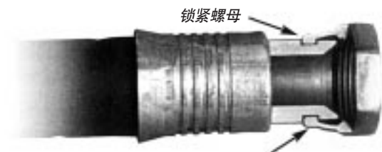
回转联接处易受超额扭矩的破坏
